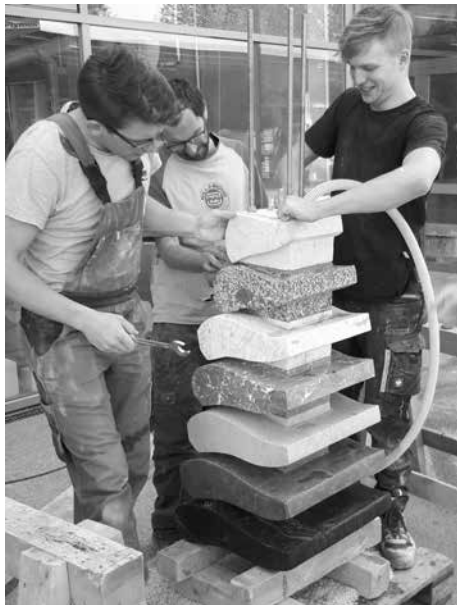
Im Bild links: Die Lehrlinge beim Montieren der einzelnen „Brunnenschalen-Elemente“, welche aus unterschiedlichen Natursteinen herausgearbeitet wurden
